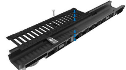
1. Отсоединить болт, и установить основную часть крепежа (без болта) в лоток.
